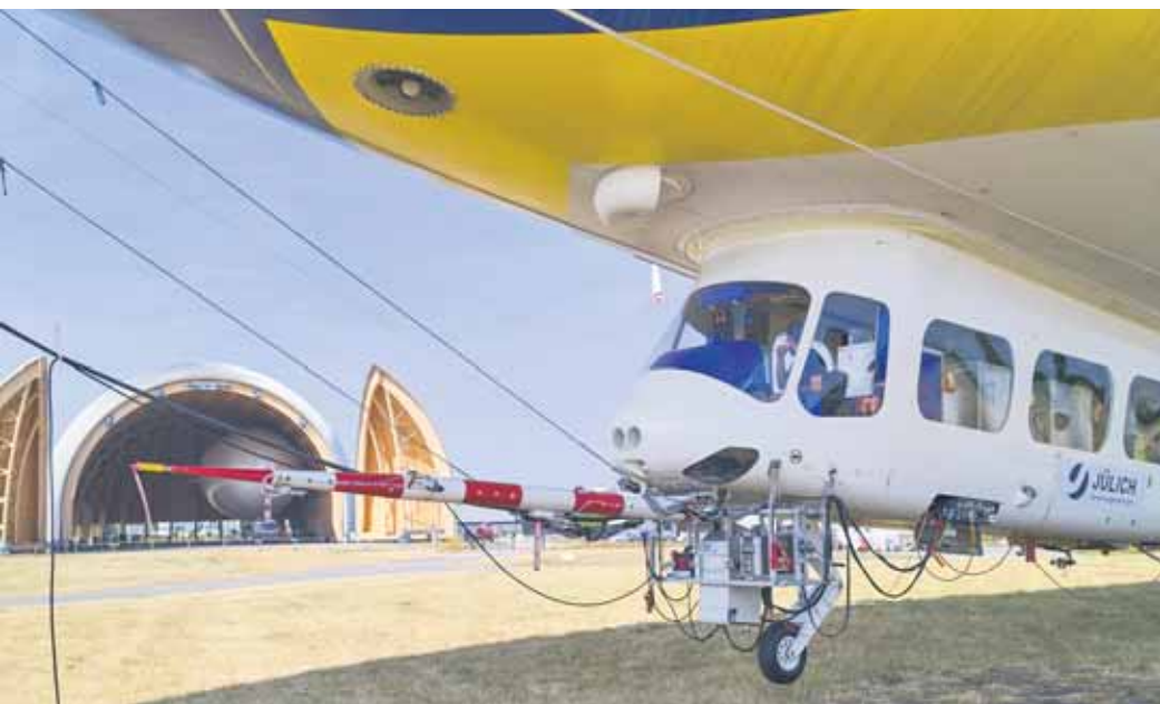
Mit hochpräzisen Messinstrumenten ausgestatteter Zeppelin vom Typ NT auf dem Luftschiffhangar Mülheim. (Foto: Mathias Martin | Universität zu Köln)
